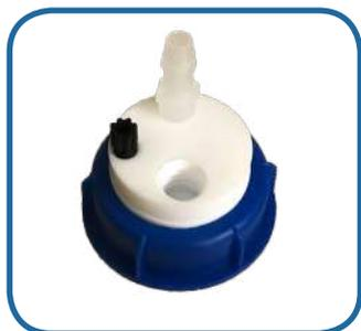
SWB-1-C-1L : 1 conector de 1/8", 1 conector leak y una entrada para carbón activado.
