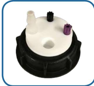
SW60-2-C-1L : 2 conectores universales 2 en 1 de 1/8", 1 conector leak y una entrada para carbón activado
