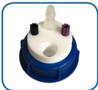
SWB-2-C-1L : 2 conectores universales 2 en 1 de 1/8", 1 conector leak y una entrada para carbón activado
