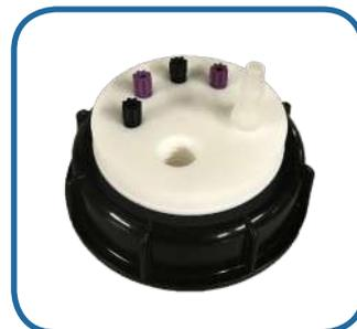
SW90-4-C-1L : 4 conectores universales 2 en 1 de 1/8", 2 conectores leak y una entrada para carbón activado
